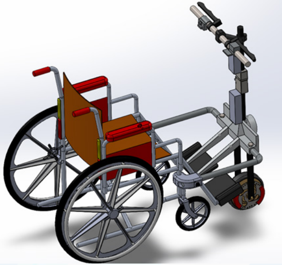
Figura 8. Patín implementado en una silla de ruedas.
