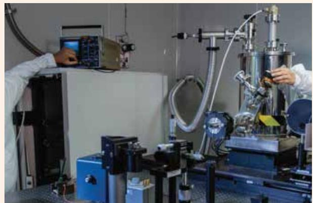
Radiómetro criogénico. Óptica y Radiometría
