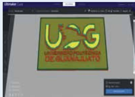
Figura 2.- Segmentación de diseño con material y máquina a utilizar en el software CURA®. Autoría propia.
