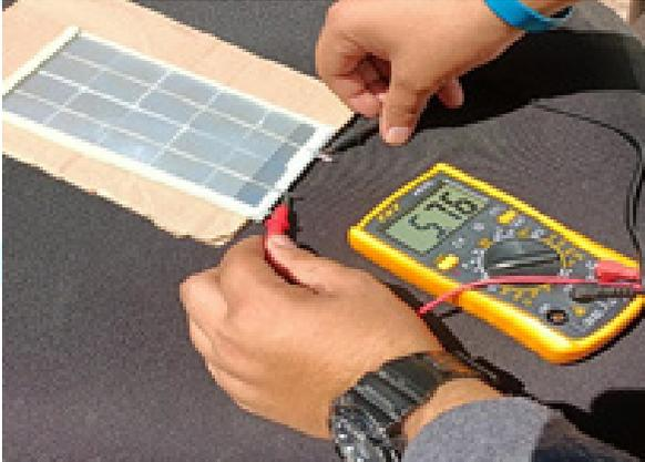
Figura 2. Panel fotovoltaico para alimentación del módulo SIM800.
